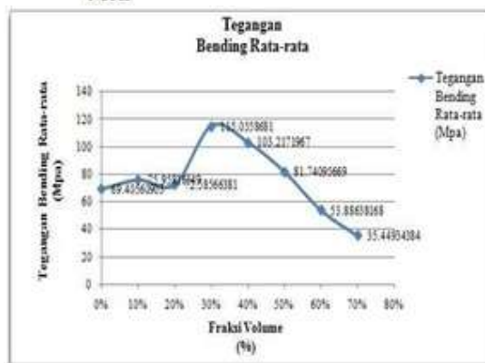
Gambar 3.7 Grafik hubungan tegangan bending rata-rata Dengan Perlakuan NaOH
